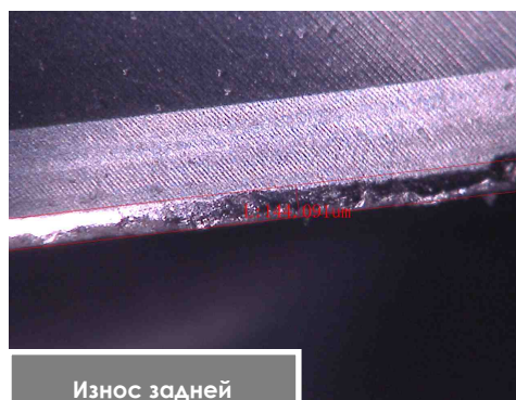
Износ задней поверхности стандартной фрезы
